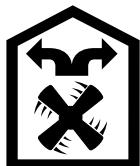
Zasysane powietrze jest oczyszczane przez filtr przeciwtłuszczowy oraz filtr z węglem aktywnym i odprowadzane z powrotem do kuchni.
