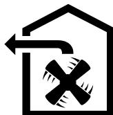
Вытяжка всасывает воздух, который очищается, проходя через жироулавливающие фильтры, а затем выводится по системе труб наружу из здания.
